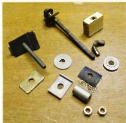
Obr. 18. Držáky na uchycení cívky při navijení
