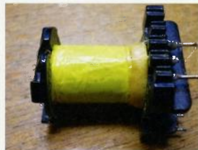
Obr. 17. Cívka připravená k převinutí
