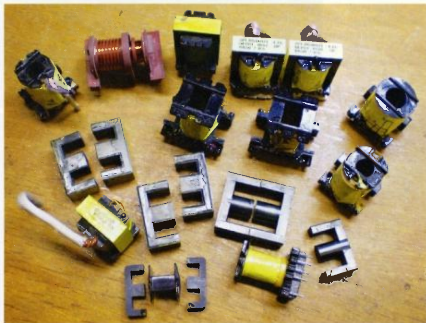
Obr. 14. Rozebrané impulzní transformátory
