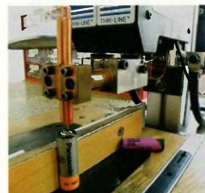
Obr. 2. Bodování pájecích vývodů
