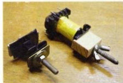
Obr. 19. Držáky s cívkami na navijení
