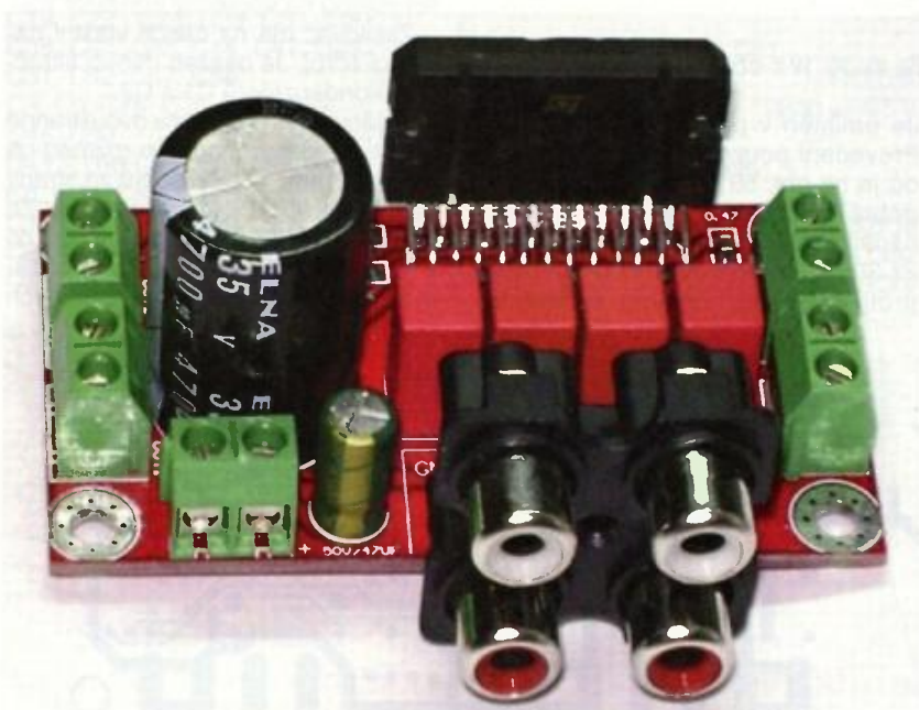
Obr. 68. Modul zesilovače 4x 50 W s obvodem TDA7850, popis bude v příštím čísle
