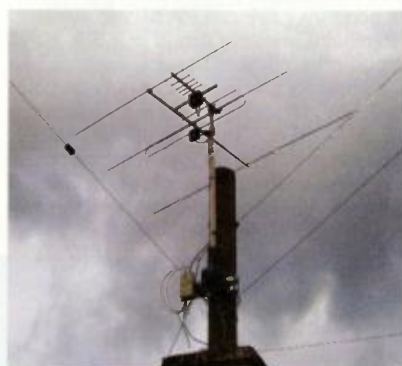
Obr. 4. Anténa 3EL Yagi pro FM CCIR
