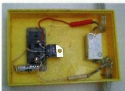
Obr. 9. Vnitřek skříňky stmívače
