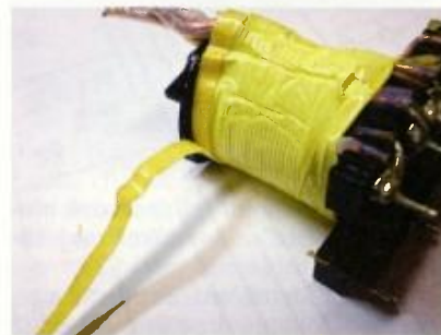
Obr. 15. Vyrovnávací a izolační pásy na okraji cívky
