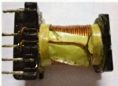
Obr. 22. Vyplnění a izolace okrajů vinutí
