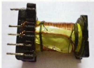
Obr. 21. Upevnění koncu a izolace vývodu vinutí
