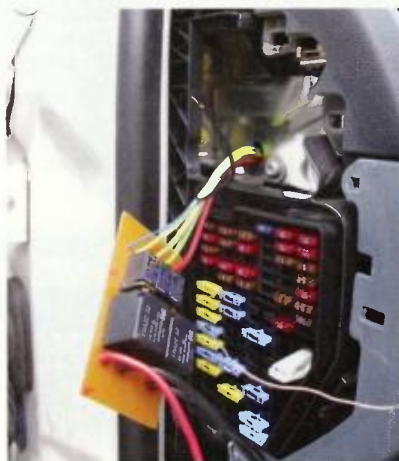
Obr. 4. Spoje je vhodné pocínovať
